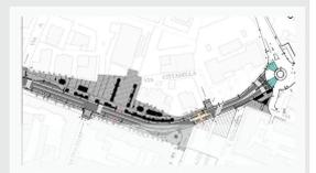
Nel tratto iniziale dalla rotonda con via Gramizzi, la pavimentazione esistente sarà rimossa e ricollocata su una nuova base di calcestruzzo armato, così come verrà mantenuta in autobloccanti la rotonda all'altezza dell'ex Macello. Particolare attenzione, nelle proposte migliorative, sarà posta a soluzioni che incidano positivamente sulla riduzione della velocità di percorrenza della strada, fattore di preoccupazione più volte segnalato all'Amministrazione dai residenti della zona.
